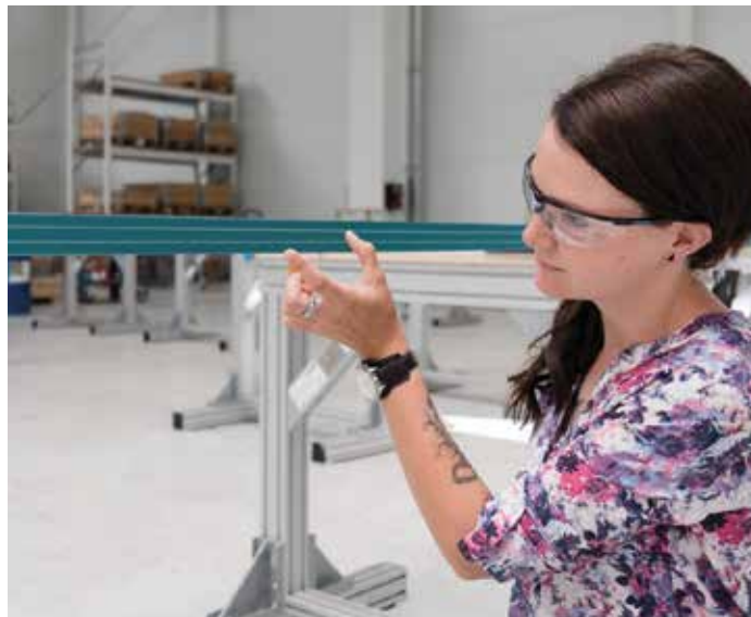
Prüfung der Kantenqualität, bevor das Laminat verpackt wird.
